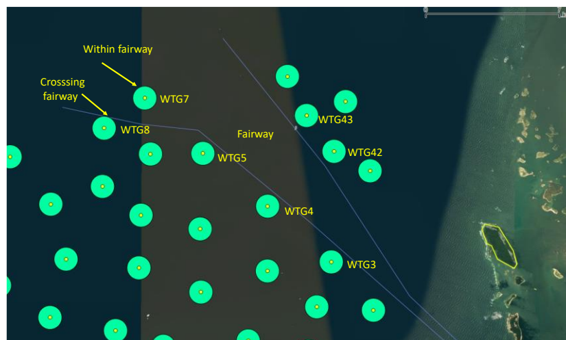
Kuva 5 Lähikuva laivaväylästä ja tuulivoimaloista väylän reunoilla. Tuulivoimaloiden ympärille on piirretty vaaleanvihreällä ympyrät, joiden säde on 301 m. Fairway = laivaväylä, WTG = tuulivoimala, Within fairway = laivaväylällä, Crossing fairway = sivuaa laivaväylää.
